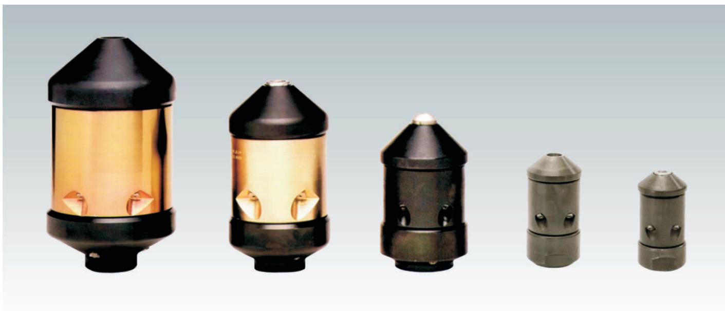
La tobera HRH es una tobera con 4 chorros rotativos a 45° hacia atrás. Los chorros limpian las paredes de la tubería y a la vez provocan una fuerza de reacción para que la tobera avance hacia delante.
