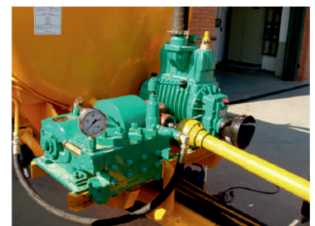
345A Accionamiento toma fuerza tractor 140 bar - 135 l/min
