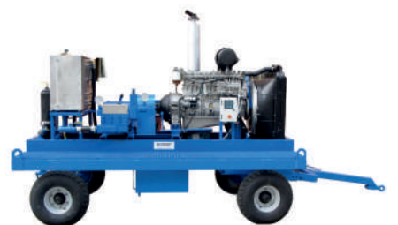
3150RA02 - 150 CV 570 bar - 94 l/min
