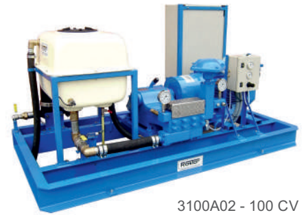
3100A02 - 100 CV 660 bar - 57 l/min
