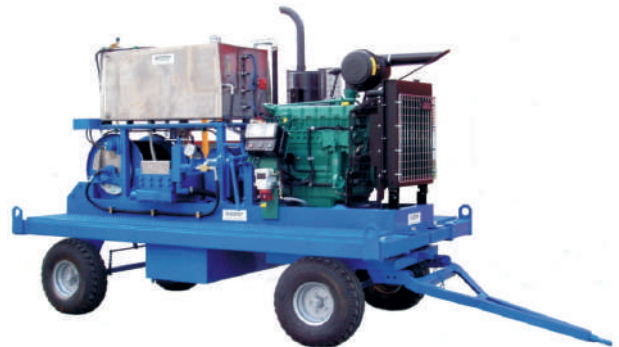
3150A02 - 150 CV 750 bar - 73 l/min
